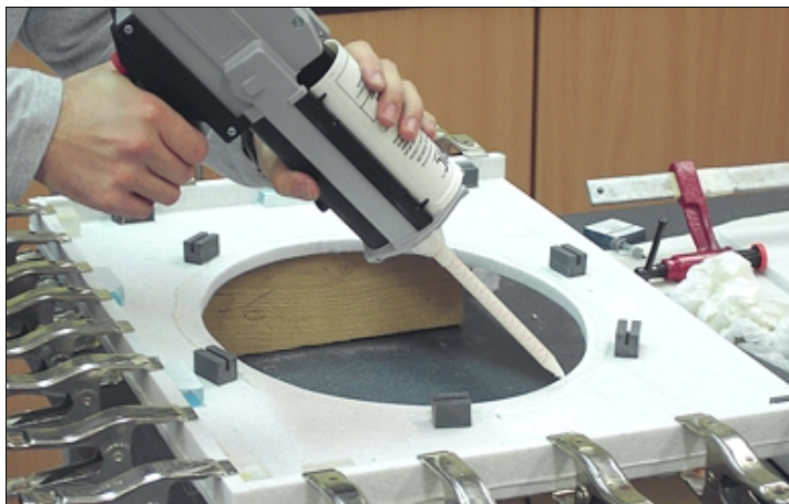
Het verlijmen gebeurt met een waterdichte tweecomponentenlijm; voor een naadloze hechting moeten de twee te verlijmen delen goed opgespannen worden
