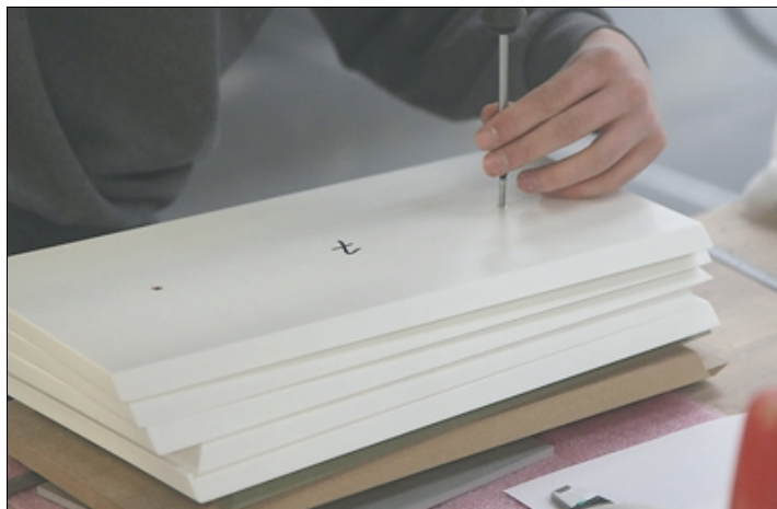
Solid Surface platen hebben een relatief grote interne spanning, waardoor men moet gaan werken met inserts waarin dan schroeven kunnen aangebracht worden
