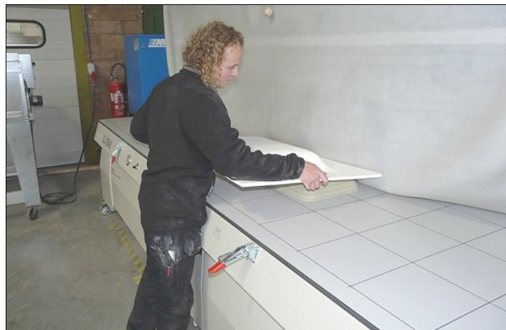
Een snelle en dus goedkopere manier van thermovormen is aan de hand van een vacuümtafel: hierbij is het immers enkel nodig om een positieve mal te maken
