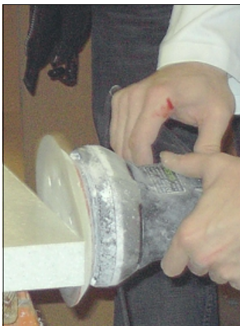
Het opschuren van een Solid Surface plaat moet steeds in verschillende fases gebeuren en dit steeds met handgereedschap; een erg arbeidsintensief karwei dus
