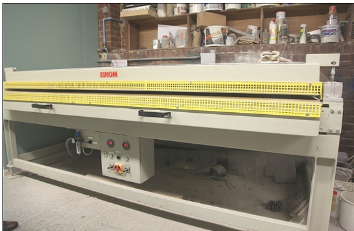
Door de Solid Surface platen te verwarmen in een speciale oven kan men ze in een plastische toestand brengen waarna ze op een mal getrokken worden
