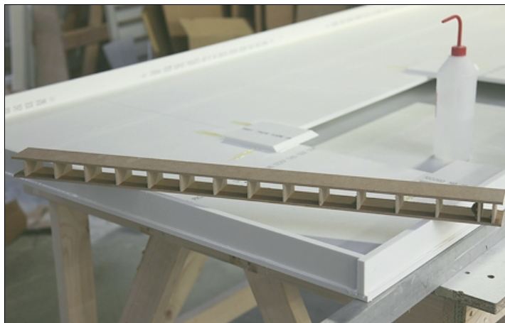
Solid Surface platen zijn geen constructiemateriaal, maar wel een bekledingsmateriaal; er moet dus steeds in een versterkende onderconstructie voorzien worden
