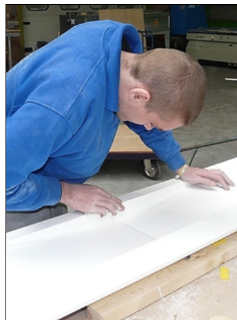
Het opschuren van een Solid Surface plaat moet steeds in verschillende fases gebeuren en dit steeds met handgereedschap; een erg arbeidsintensief karwei dus
